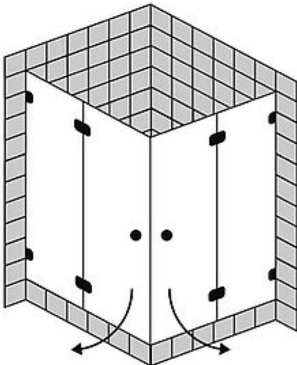
**FORMAT Design 3.0** Ganzglas-Eckeingang, Höhe bis 2000 mm
