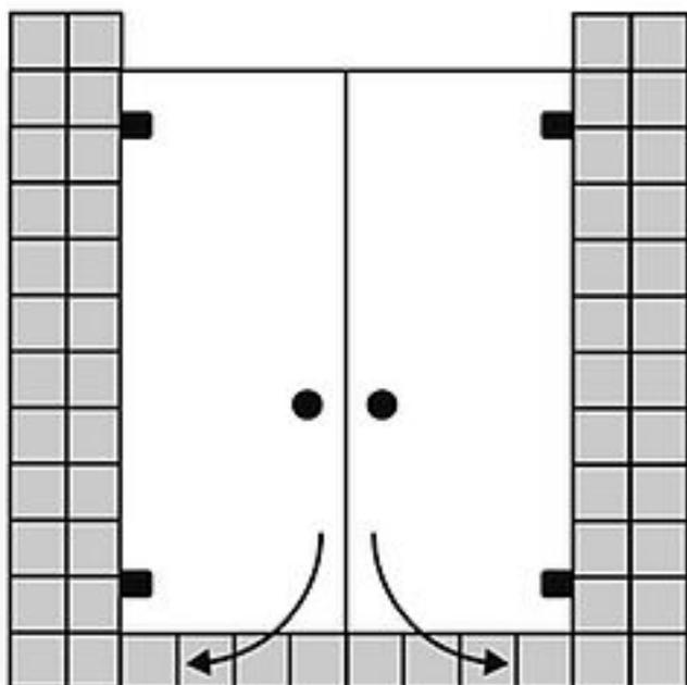
**FORMAT Design 3.0** Ganzglas-Drehtür für Nische, Höhe bis 2000 mm
