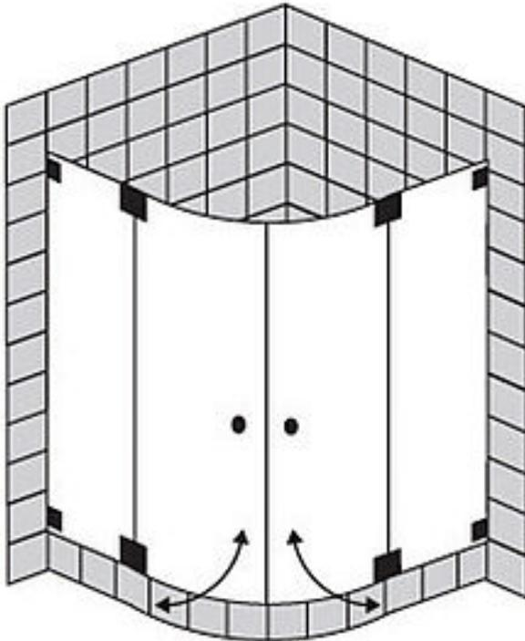
**FORMAT Design 3.0** Ganzglas-Viertelkreisdusche mit 2 Pendeltüren, Höhe bis 2000 mm
