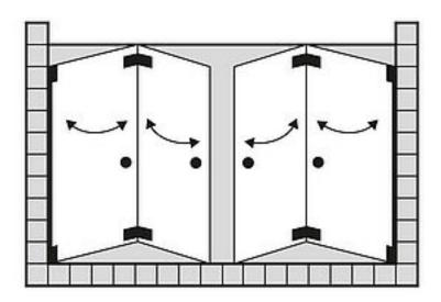
FORMAT Design 3.0 Ganzglas-Doppel-Falttür, Höhe bis 2000 mm
