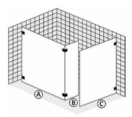
FORMAT Design 3.0 Walk-In Trennwand mit Festfeld/Seitenwand, Höhe bis 2100 mm
